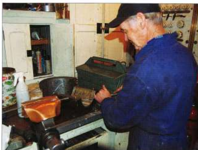
Mats Demker "härver in" en halvvan till ett av ramlagren. Den andra halvvan syns strax bakom. Foto 29 januari 2009 Bo Starmark
