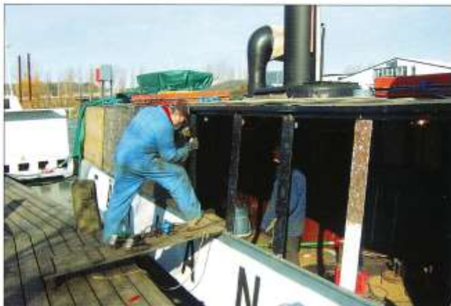
Bert Johansson passar in nya plåtar mellan den nyreparerade stringerplåten med sitt Z-järn och överbyggnadssidan.
